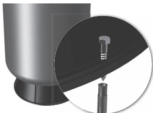
Rys. 4 Montaż zbiornika z podstawą z tworzywa sztucznego
